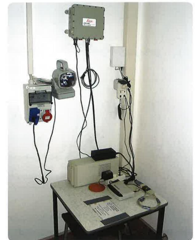
**Abb. 16:** Weitere wesentliche Bestandteile einer der beiden GPS-Permanentstationen. An der Wand hängend ist der GPS-Empfänger montiert. Dieser wird durch eine unterbrechungsfreie Stromversorgung gespeist und ist an eine ISDN-Verbindung für die Datenfernübertragung zur TU Dresden angeschlossen.
